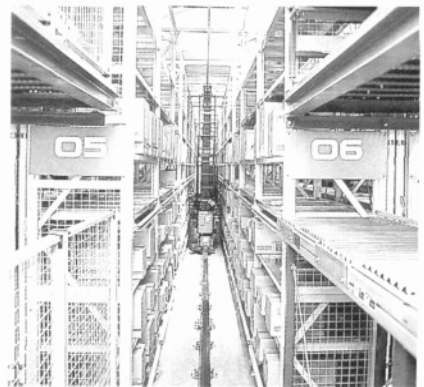
常温品的箱子自动仓库。自动补充到散装货品区域。
