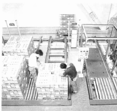
1 楼人工分拣台。封装票据以及进行紧急处理。
