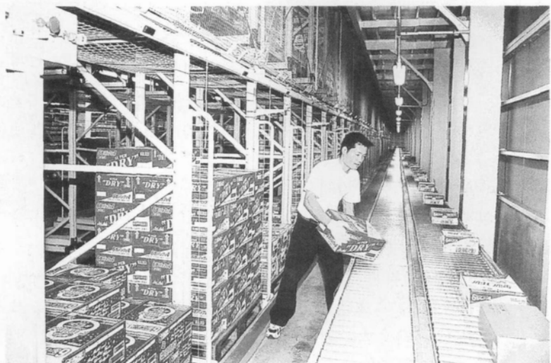
▲箱式(B品)拣选区域。从 CS(左侧)直接拣选。
